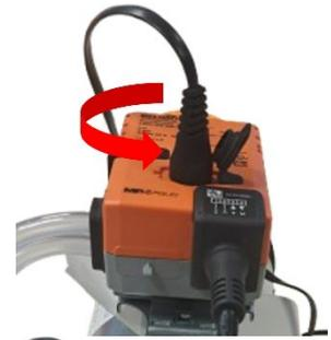
3. Verbinden Sie den Antrieb durch das andere Ende des Kabels mit dem ZTH-Tool.
