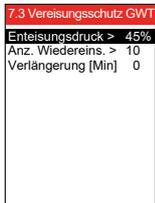
Im Menü den Druckverlustanstieg in Prozent (im Verhältnis zu einem sauberen Wärmetauscher) wählen, bei dem die Enteisung aktiviert werden soll. Es wird empfohlen, den ab Werk eingestellten Enteisungsdruck in speziellen Situationen zu ändern.
