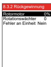
Wenn der Rotormotor nicht fehlerhaft ist (Nein neben „Störung der Einheit“), kann der Zwangsstart aktiviert werden.
