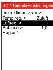
Das Regelverfahren kann unter den Verfahren in der Übersicht gewählt werden. Es wird darauf hingewiesen, dass einige der Verfahren die Montage von Extraausrüstung in der Form eines Druckmessfühlers in einem oder mehreren Kanälen (MPTDUCT) erfordern.
