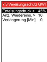
Im Menü den Druckverlustanstieg in Prozent (im Verhältnis zu einem sauberen Wärmetauscher) wählen, bei dem die Enteisung aktiviert werden soll. Der Enteisungsdruck kann zwischen 25 und 60 % eingestellt werden. Es wird empfohlen, den werksseitig eingestellten Enteisungsdruck von 45 % (Erfahrungswert) nur in speziellen Situationen zu ändern.
