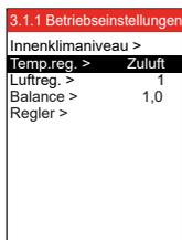
Wenn Temp. reg. von Zuluft auf Raum geändert wird, treten die auf den nächsten Seiten beschriebenen Funktionalitäten in Kraft, und ungültige Werte werden in gültige Werte geändert. Wenn Temp. reg. von Raum auf Zuluft geändert wird, passiert nichts, denn die Grenzwerte für Raum liegen stets innerhalb der Grenzwerte für Zuluft.
