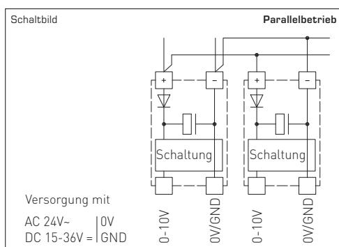
Werden mehrere Geräte von einer 24V AC-Spannung versorgt, ist darauf zu achten, dass alle „positiven“ Betriebsspannungseingänge (+) der Feldgeräte miteinander verbunden sind, sowie alle „negativen“ Betriebsspannungseingänge (-) = Bezugspotential miteinander verbunden sind (phasengleicher Anschluss der Feldgeräte). Alle Feldgeräteausgänge müssen auf das gleiche Potential bezogen werden!
