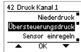
Danach lässt sich der Druck beim Betriebsmodus Übersteuerungsdruck im Betriebsbereich des Drucksensors einstellen. Wenn der Betriebsbereich des Drucksensors beispielsweise im Intervall *0 bis 500 Pa* eingestellt ist, lässt sich der Übersteuerungsdruck in diesem ganzen Intervall einstellen.
