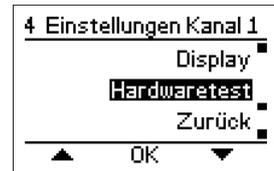
**Alarmrelais** Manuelles Ein- bzw. Ausschalten des Alarmrelais. Während des Tests wird ein eventuelles Alarmsignal zum Relais übersteuert.
