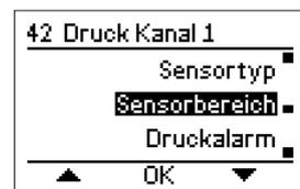
Mit den Tasten ▲ und ▼ den Druckbereich wählen und dann die Taste **OK** drücken.
