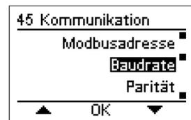
Die Taste **OK** drücken, um die Kommunikationsgeschwindigkeit zu bestätigen.
