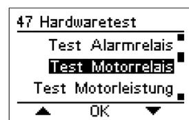
Mit den Tasten ▲ und ▼ den Zustand des Motorrelais wählen. Die Taste **OK** drücken, um den Test zu verlassen.
