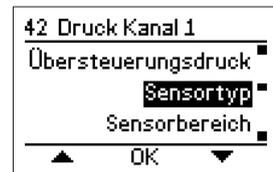
Mit den Tasten ▲ und ▼ den Drucksensortyp wählen und dann die Taste **OK** drücken.
