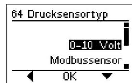
Wenn der gewählte Drucksensor ein 0-10 VD-gestützter Sensor ist, ist der Solldruckbereich anzugeben. Dies erfolgt automatisch, wenn ein Modbus-gestützter Drucksensor benutzt wird. Die Taste  $\blacktriangledown$  zum Wechseln zwischen den Wahlmöglichkeiten benutzen. **OK** drücken, um den gewünschten Druckbereich zu wählen.
