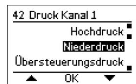
Danach lässt sich der Druck beim Betriebsmodus Niederdruck innerhalb des Betriebsbereichs des Drucksensors einstellen. Wenn der Betriebsbereich des Drucksensors beispielsweise im Intervall *0 bis 500 Pa* eingestellt ist, lässt sich in diesem ganzen Intervall Niederdruck einstellen.
