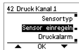
Wenn der Druckmesswertgeber druckneutral ist, die **Ja**-Taste drücken, um eine Einregelung des Drucksensors vorzunehmen.
