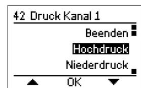
Danach lässt sich der Druck beim Betriebsmodus Hochdruck innerhalb des Betriebsbereichs des Drucksensors einstellen. Wenn der Betriebsbereich des Drucksensors beispielsweise im Intervall 0 bis 500 Pa eingestellt ist, lässt sich in diesem ganzen Intervall Hochdruck einstellen.
