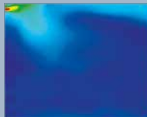
Zuluftstrom mit Coanda-Effekt. Gute Luftverteilung, geringe Restgeschwindigkeit im Aufenthaltsbereich.
