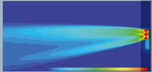
Simulation von LINED® Combined inkl. der Darstellung des Coanda-Effekts und der nicht vorhandenen Rückführung (Bypass) der Luft.
