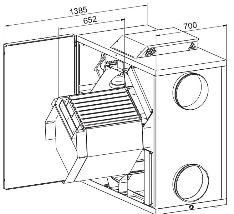
**Hinweis:** Zwecks Wartung des VEX-Geräts ist eine lichte Höhe von mindestens 300 mm über dem Anschlusskasten erforderlich.
