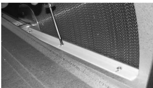
Die Dichtleiste auf der Spülkammer mit Schrauben montieren.
