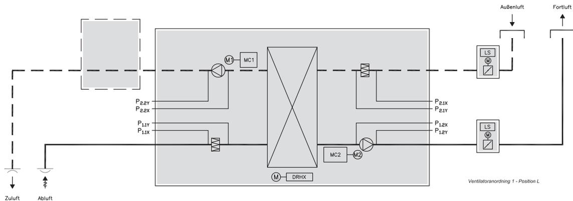
Die Prinzipskizze zeigt ein VEX-Gerät mit Ventilatoranordnung 1, links.
