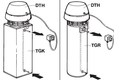
Die Dachdurchführung ist innen mit einem Kabelkanal ausgerüstet, in dem das Installationskabel für die Versorgungstrennung verlegt wird.
