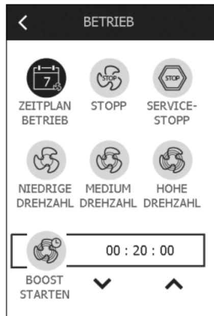
Bei „hohe Drehzahl“ wird das voreingestellte Programm außer Kraft gesetzt, und der Lüfter läuft mit hoher Drehzahl.
