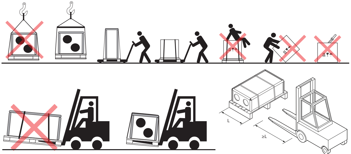
Fig. 4. Eksempler på transport med kran, gaffeltruck og vogn
