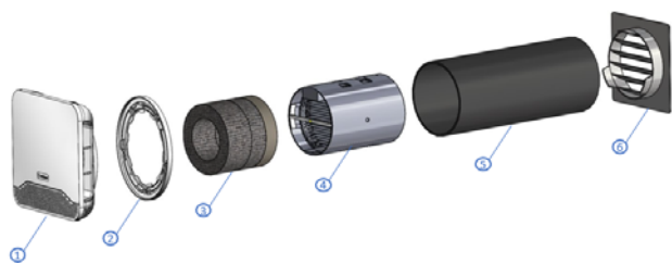
Figure 28 – Mise en œuvre entrée d’air EHT 2 ou EFT 2 avec électrofiltre EHT 2 /EFT 2 Ø 125 mm L 300 mm
