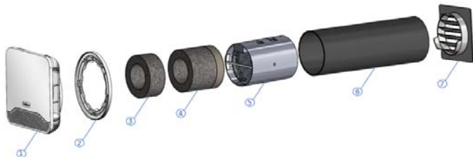
Figure 28 – Mise en œuvre entrée d’air EHT 2 ou EFT 2 avec électrofiltre EHT 2 /EFT 2 Ø 125 mm L 300 mm
