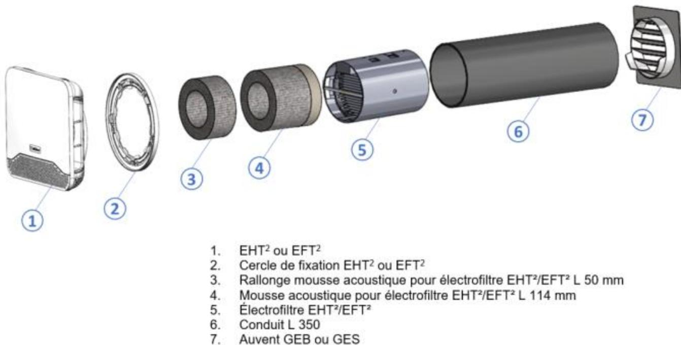
**Figure 29 – Mise en œuvre entrée d'air EHT<sup>2</sup> ou EFT<sup>2</sup> avec électrofiltre EHT<sup>2</sup>/EFT<sup>2</sup> Ø 125 mm L 350 mm**
