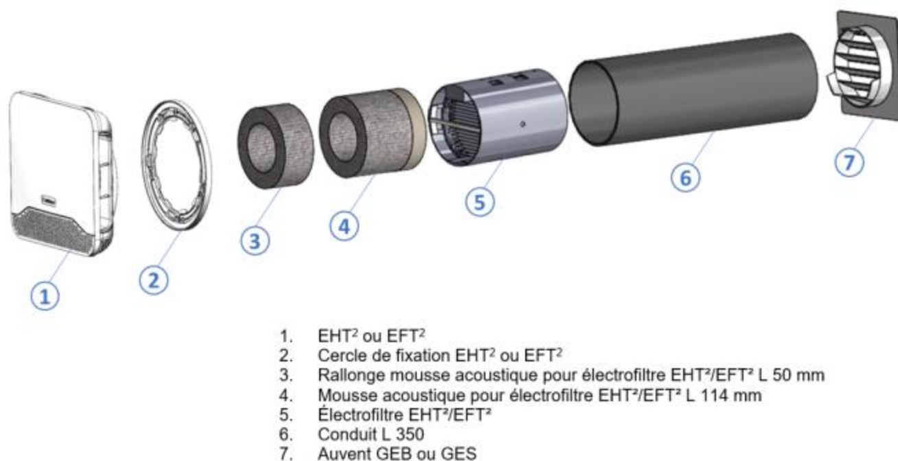
Figure 29 – Mise en œuvre entrée d'air EHT² ou EFT² avec électrofiltre EHT²/EFT² Ø 125 mm L 350 mm
