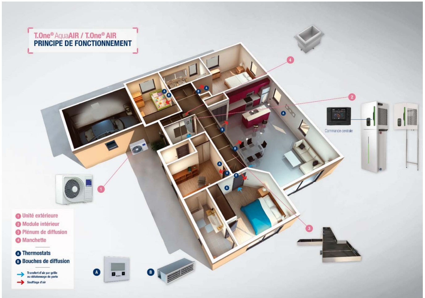
Figure 1 – Schéma de principe du système « T.One® AIR », « T.One® AIR R32 » ou « T.One® AquaAIR »
