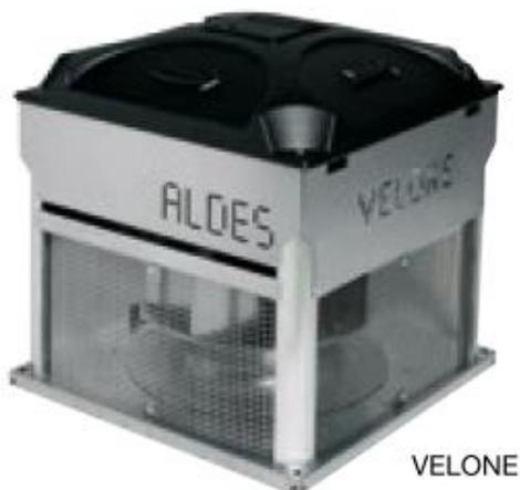
La tourelle d'extraction des fumées sera de marque ALDES ou équivalent de type « VELONE F400 », comprenant l'asservissement électrique à l'installation d'extraction / Détection incendie. La tourelle aura les caractéristiques suivantes :
