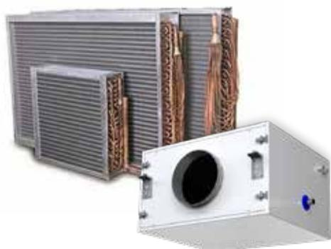
Ce module externe, prévu spécialement pour les DFE Compact, peut être monté sur la gaine de pulsion ou directement sur l'unité. Il comprend une batterie à eau (chaude/froide) ou à condensation/évaporation à 4 rangs qui sert de pré- et/ou postchauffe pour l'air neuf. Si le module inclus une batterie à eau, il est livré prêt à connecter sur le circuit hydraulique
