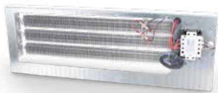
Les unités DFE Compact peuvent être équipées d'éléments chauffants en entrée (préchauffe). Il est possible d'intégrer une batterie électrique de préchauffe pour éviter le risque de gel de l'échangeur en cas de températures très basses à l'aspiration extérieure. Celle-ci est livrée entièrement pré-câblée à la régulation TAC5 et permet de descendre jusqu'à une température d'environ -40°C (voir tableau ci-dessous) à l'aspiration pour une température intérieure de +22°C,
