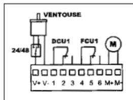
**Déclencheur électromagnétique** équipé de ventouse bitension 3 fils, la tension est pré-réglée en usine conformément à la commande client, elle peut être modifiée grâce à un commutateur (voir schéma).
