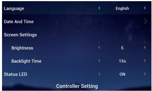
① Dans l'interface du menu, tournez le commutateur rotatif pour sélectionner « Réglages contrôleur » (réglages contrôleur s'illumine) ;
