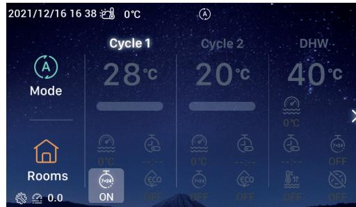
Pași pentru a seta TempORIZATOR săptămânal Ciclu 1 OPRIT sunt identici cu cei de la TempORIZATOR săptămânal PORNIT. Când TempORIZATOR săptămânal OPRIT a fost setat cu succes, sub pictograma temporizatorului săptămânal din interfața principală se afișează OFF .
