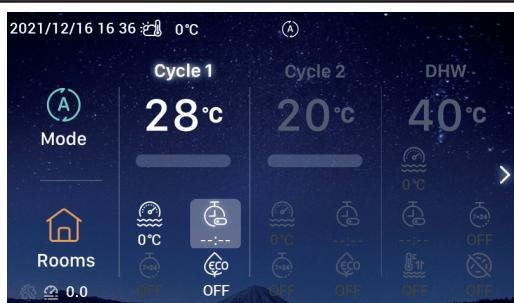
Setarea Temporizator OPRIT în timpul funcționării Ciclului 1 este identică cu cea a Temporizator PORNIT.
