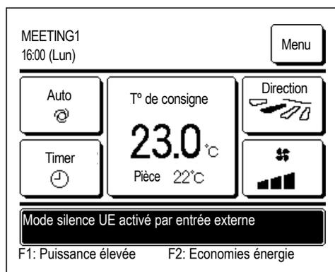
Lorsque le message « Mode silence UE activé par entrée externe » est affiché, l'unité fonctionne dans les mêmes conditions que lorsque la programmation du mode silencieux est mise en place (→ page 75) via la télécommande.
