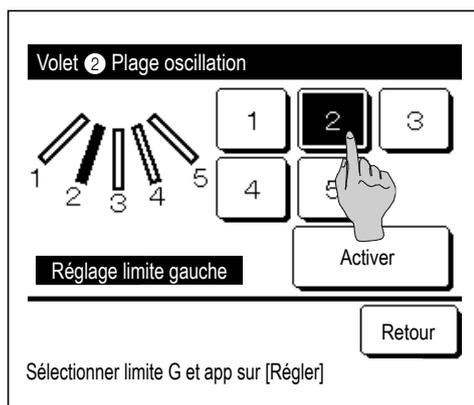
**8** Sélectionner l'une des limites de position latérales à gauche de **1** à **5** pour régler la plage de mouvement du volet.
