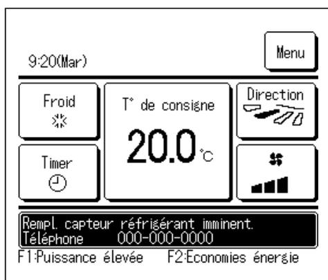
Le capteur de réfrigérant est un composant qui nécessite un entretien régulier. Lorsque l'entretien du capteur de réfrigérant doit être effectué, le message affiché à gauche apparaît.
