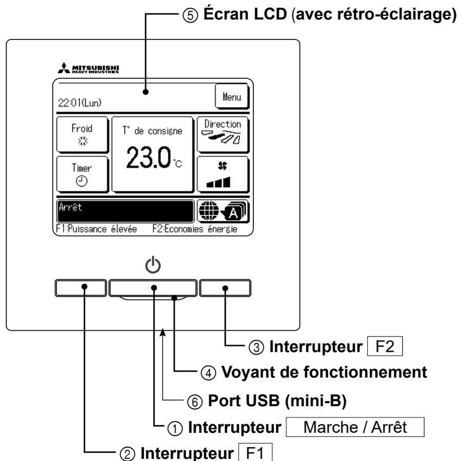
L'écran tactile, activé par une pression du doigt sur l'écran LCD, est utilisé pour toutes les fonctions à l'exception de celles assurées par les interrupteurs ① Marche/Arrêt, ② F1 et ③ F2.
