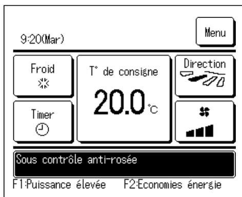
Si l'humidité autour de l'U. I. est élevée, la vitesse de ventilation et la direction du volet peut différer de la vitesse de ventilation et de la direction réglées pour éviter la formation de condensation sur l'U. I.. L'anti-courant d'air peut également se fermer.
