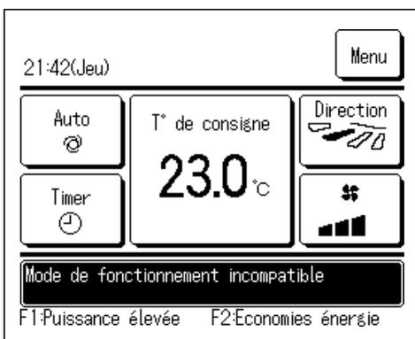
Si le climatiseur est un système de climatisation pour bâtiments de type multiple, les fonctions de refroidissement et de chauffage ne peuvent pas être mélangées pour les U. I. dans certains cas (toutes les U. I. connectées seront dans le même mode de fonctionnement en fonction du modèle de l'U. E.).
