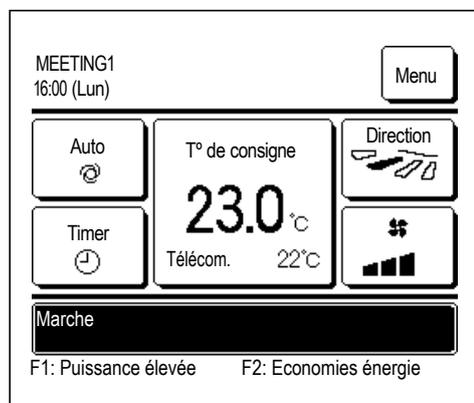
Lorsque le réglage du capteur de la télécommande est désactivé, la température de la pièce 0°C est affichée.
