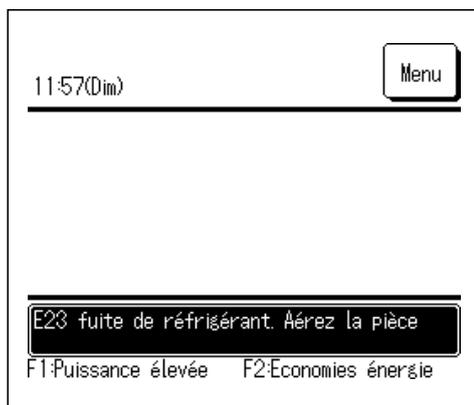
Ce message s'affiche si le détecteur de réfrigérant détecte une fuite de réfrigérant.
