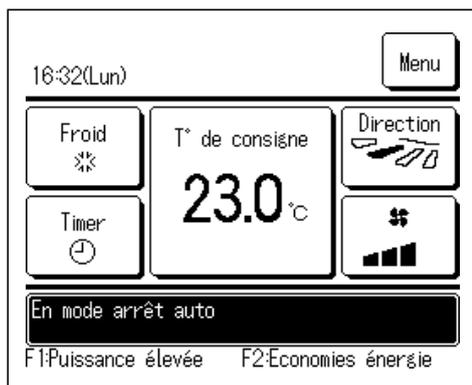
Ce message s'affiche dans la zone d'emplacement des messages lorsque le contrôle de puissance du contrôle du détecteur de mouvement (☞ page 29) est activé et que le contrôle de l'arrêt automatique est exécuté dans l'état « Fonctionnement - en attente ». Le climatiseur s'arrête pendant « Fonctionnement - en attente », et se remet en marche dès qu'une présence humaine est détectée.
