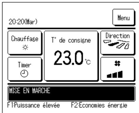
Ce message s'affiche dans la zone d'emplacement des messages lorsque le contrôle de puissance du contrôle du détecteur de mouvement (☞ page 29) est activé et que le contrôle de puissance est exécuté. La température corrigée est également affichée pour la température de consigne par le contrôle de puissance.
