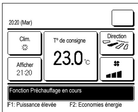
Si le chauffage est activé par une Réglage ON par décompte (page 44) ou par une Réglage ON par définition d'une heure (page 47), l'unité démarrera entre 50 et 60 minutes avant l'heure prévue, en fonction du dernier chauffage effectué, afin que la pièce soit préchauffée à un niveau proche de la température de consigne avant que le mode chauffage ne soit activé.
