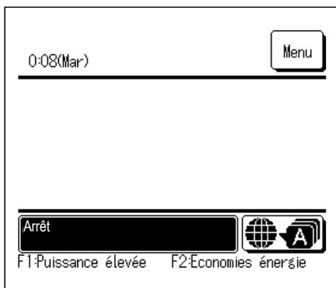
Quand l'appareil s'arrête, toutes les touches de fonctionnement de l'écran s'éteignent. Quand la durée de maintien du rétro-éclairage (☞ page 41) est atteinte, le rétro-éclairage s'éteint.
