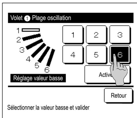
**5** Sélectionner l'une des limites de position inférieures de **1** à **6** pour modifier la plage de mouvement du volet.
