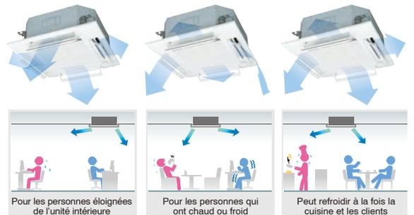
Les volets peuvent être réglés sur une plage de positions, qui peuvent être sélectionnées à l'aide d'une télécommande fixe.
