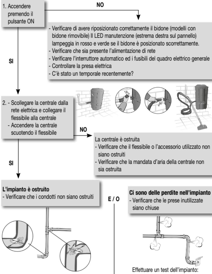
Effettuare un test dell'impianto con tutte le prese di aspirazione chiuse, premendo per 3 secondi sul pulsante "Test" della centrale. Verde = rete OK / Arancio = rete di aspirazione OK, lievi fughe d'aria rilevate / Rosso = perdita => Verificare i condotti e poi effettuare un nuovo test
