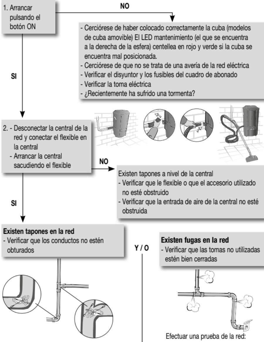
Efectuar una prueba red con todas las tomas de aspiración cerradas y manteniendo 3 segundos el botón "Prueba" de la central. Verde = red OK, / naranja = Red OK, poca fuga / Rojo = fuga => Verificar los conductos y efectuar una nueva prueba.
