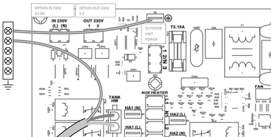
**IMPORTANT :** L'ensemble des câbles ballon doit être attaché par un collier au niveau de l'encoche prévue sur la tôle support carte (voir début paragraphe 4.8).
