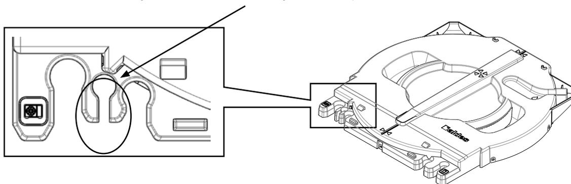
Ces câbles doivent être fixés à l'aide des deux passes câbles de l'unité supérieure, cela est nécessaire pour ne pas gêner la mise en place de la façade, (voir schéma précédent).
