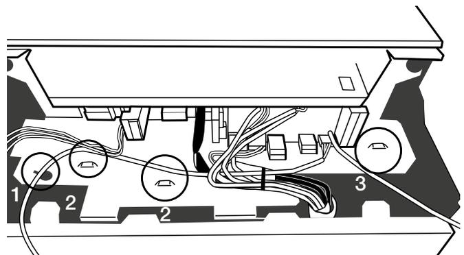
N'utilisez pas le même câble pour l'alimentation et les signaux de commande. Cela risquerait de créer des dysfonctionnements et une mauvaise transmission.
