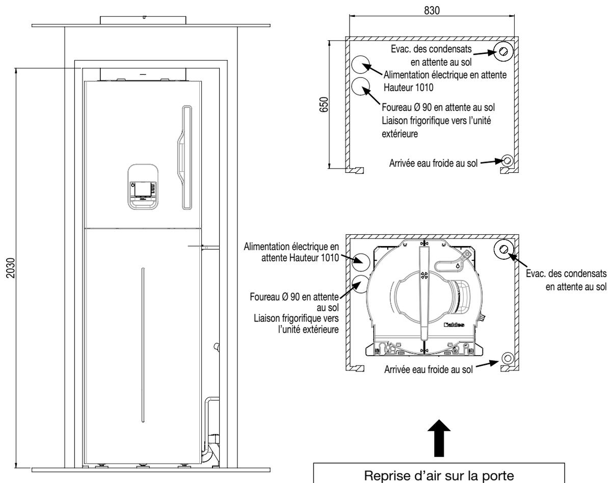
\* En cas d'installation d'un vase d'expansion, prévoir une largeur de placard de 950mm
