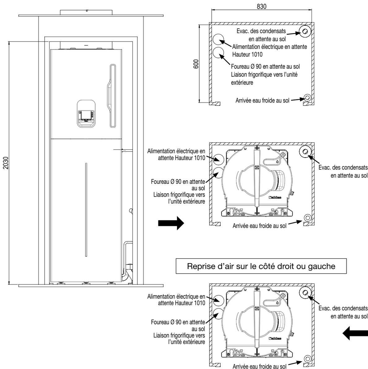
\* En cas d'installation d'un vase d'expansion, prévoir une largeur de placard de 950mm
