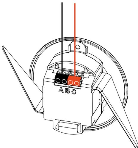
2. Installer le détecteur dans le faux-plafond. Les détecteurs se fixent grâce à 2 griffes dans le faux-plafond (Présence et Agito) ou au mur (Présence uniquement) dans un trou de diamètre 62 à 70 mm, à une hauteur maximale de 3,5 m (plafond) et 2,5 m (mur).
