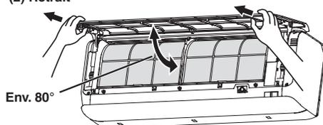
Soulevez A juste en dessous du niveau (environ 80 degrés). Tenez les deux panneaux et extrayez-les à l'avant.
