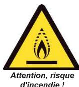
**Cet appareil est rempli de R32, un frigorigène inodore à vitesse de combustion lente. En cas de fuite de frigorigène, il existe un risque d'incendie si celui-ci est exposé à une source d'inflammation externe.**
