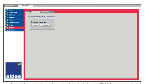
Les réglages d'usine qui sont lus à l'aide du bouton Télécharger sont les réglages d'usine qui sont enregistrés sous Modules EXcon > Usine > Télécharger/Enregistrer.
