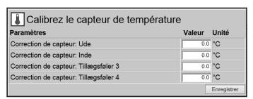
• Effectuer une correction individuelle pour chacun des capteurs thermiques. Plage de réglage : de - 3,5 à + 3,5 °C
