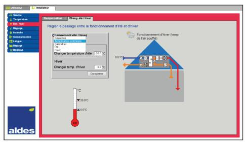
Le mode de régulation peut changer entre Température ambiante constante en mode de fonctionnement d'hiver et Température de l'air soufflé constante en mode de fonctionnement d'été.
