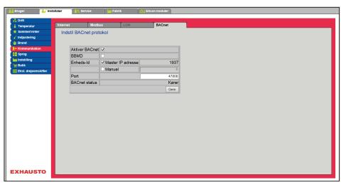
BACnet TCP/IP pour branchement externe du BACnet à un dispositif BMS/CTS, par exemple
