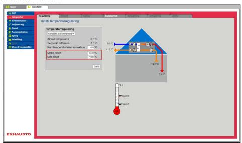
• La température est régulée en fonction de la différence de température entre l'air soufflé et l'air extrait.
