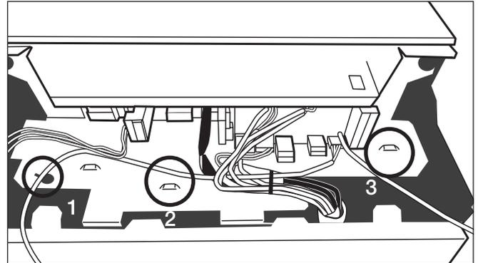
N'utilisez pas le même câble pour l'alimentation et les signaux de commande. Cela risquerait de créer des dysfonctionnements et une mauvaise transmission. Pour réaliser les raccordements, il faut accéder à la carte électronique qui se situe en haut de l'unité supérieure, il faut dévisser les deux vis du cache, voir le schéma ci-dessous :
