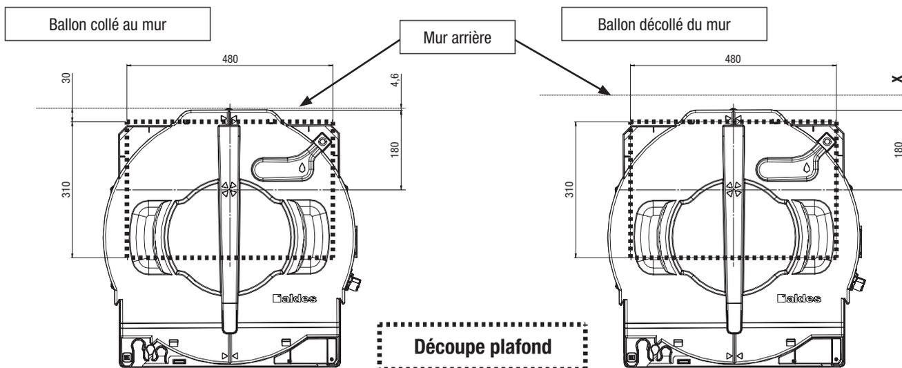
X : Distance entre le couvercle et le mur (à mesurer par l'installateur)
