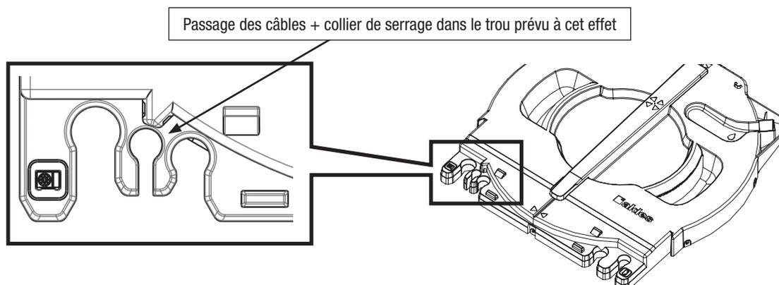
Ces câbles doivent être fixés à l'aide des deux passes câbles de l'unité supérieure, cela est nécessaire pour ne pas gêner la mise en place de la façade, (voir schéma précédent).
