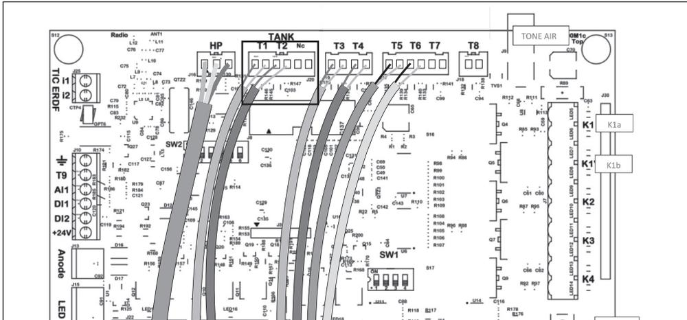
Connectez le câble de « l'appoint électrique » sur la borne « Tank HW » (phase/neutre) et le câble de terre sur la barrette prévue à cet effet comme indiqué sur le schéma n°2.
