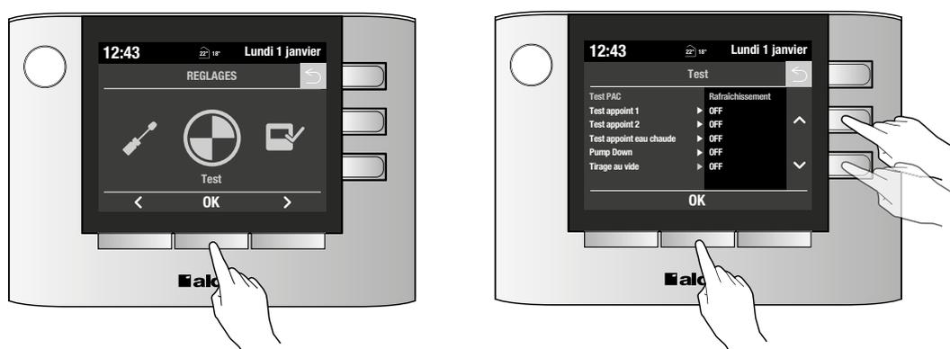
Une fois le mode sélectionné et validé (bouton OK), toutes les bouches vont s'ouvrir et le compresseur va démarrer. Le ventilateur intérieur va également démarrer au bout d'une minute d'attente.
