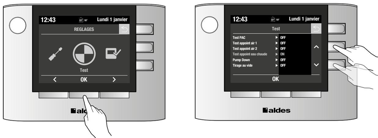
Une fois le test sélectionné et validé (bouton OK), le système lance le test de l'appoint ECS (durée de quelques secondes) afin de vérifier que celui-ci est bien fonctionnel. En cas de problème, le défaut 2D apparaît.
