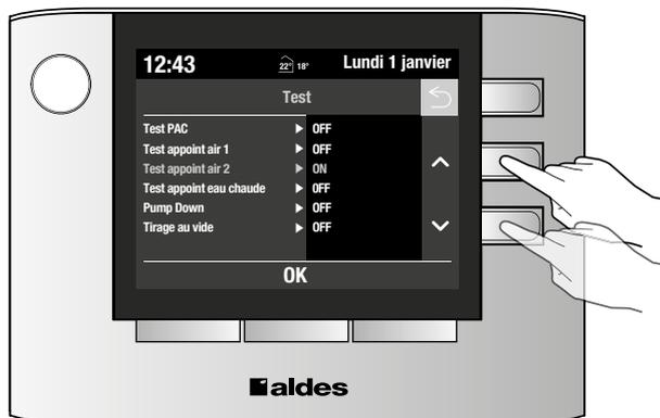
Une fois le mode sélectionné et validé (bouton OK), toutes les bouches vont s'ouvrir et le ventilateur intérieur va également démarrer au bout d'une minute d'attente, le temps que les bouches de soufflage soient réellement ouvertes.
