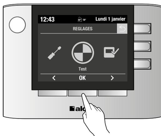
Une fois le mode sélectionné et validé (bouton OK), toutes les bouches vont s'ouvrir et le compresseur va démarrer. Le ventilateur intérieur va également démarrer au bout d'une minute d'attente.
