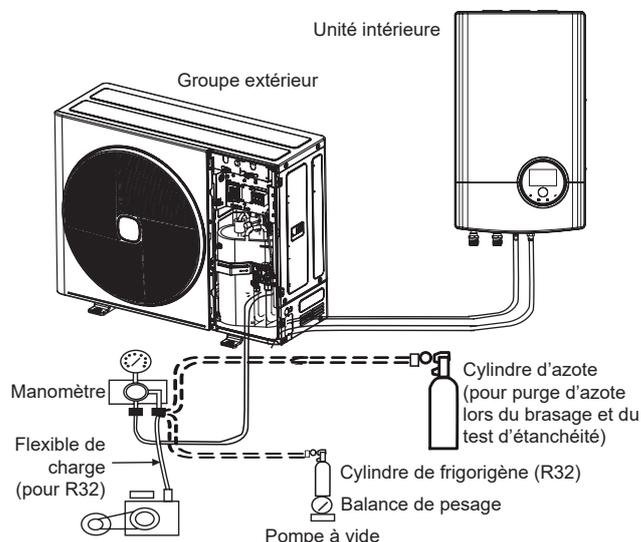
3. Une fois le pompage à vide terminé, fermez le manomètre, arrêtez la pompe à vide et laissez le dispositif se reposer pendant une heure. Vérifiez que la pression du manomètre n'augmente pas.
