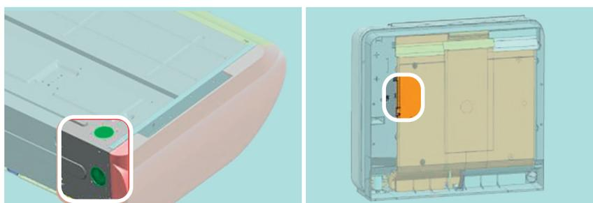
Les consoles et plafonniers convertibles sont équipés d'une prise d'air neuf.
