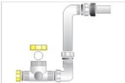
Siphon de taille DN32 pour l'évacuation du condensat de l'appareil.
