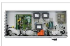
La boîte de raccordement facilement accessible dotée d'interrupteurs d'alimentation automatiques permet un accès simple pour les raccordements et les réglages.
