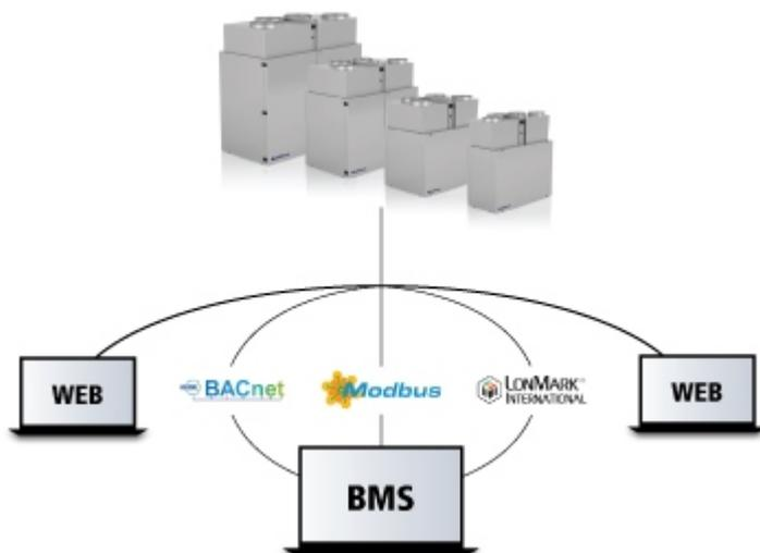
Tous les appareils VEX300T peuvent être fournis avec un système de régulation intégré pour la commande par ex. des débits d'air, du chauffage et du refroidissement. Les réglages définitifs s'effectuent directement via la régulation à partir de la télécommande ou d'un serveur Web.
