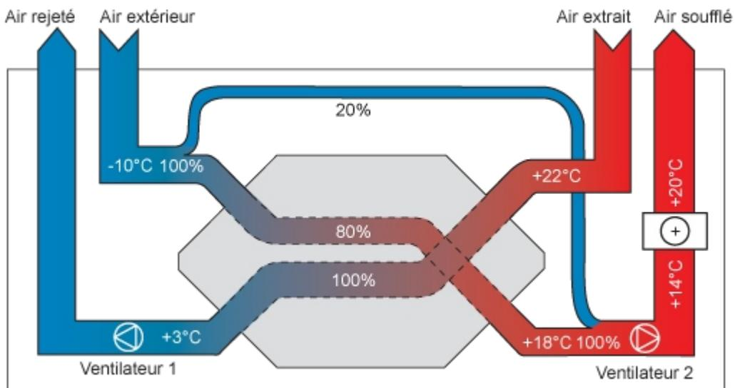
L'échangeur de chaleur peut être protégé contre le gel par commande thermique. Même le dégivrage peut se dérouler différemment, selon qu'une batterie de chauffage a posteriori soit installée ou non. La batterie de chauffage électrique est toujours recommandée pour garantir une ventilation continue.
