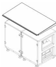
Toit VEX700H Toit indispensable pour toute installation extérieure à monter sur chantier.
