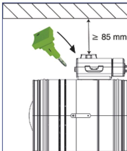
Nota : Le boîtier mécanisme doit rester accessible après la pose du clapet. Prévoir une trappe de visite à cet effet et un espace d'au moins 85 mm entre le mécanisme et la paroi adjacente.
