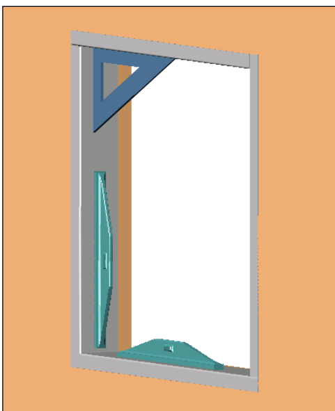
5 – Sceller le cadre dans le mur, en prenant soin de vérifier l'équerrage et l'aplomb des traverses, suivant "les règles de l'art".
