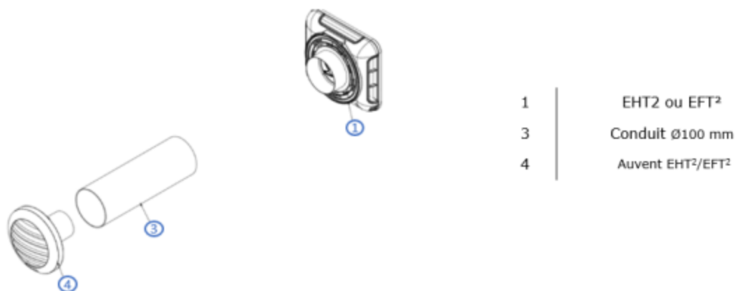
Figure 24 – Mise en œuvre entrée d'air EHT 2 et EFT 2 sans mousse \varnothing 100 mm L 300 mm
