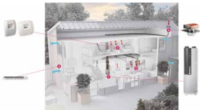
Principe de fonctionnement de la solution T.Flow® Hygro+ / Nano en Maison Individuelle
