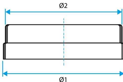
Schéma d'encombrement Bouchon Mâle Femelle
