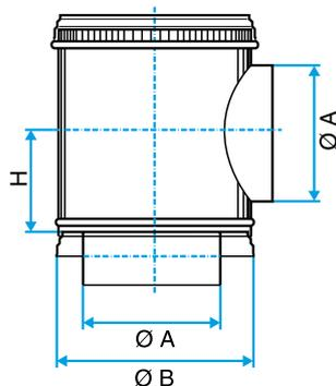
Schéma d'encombrement Caisson Piquage en aluminium
