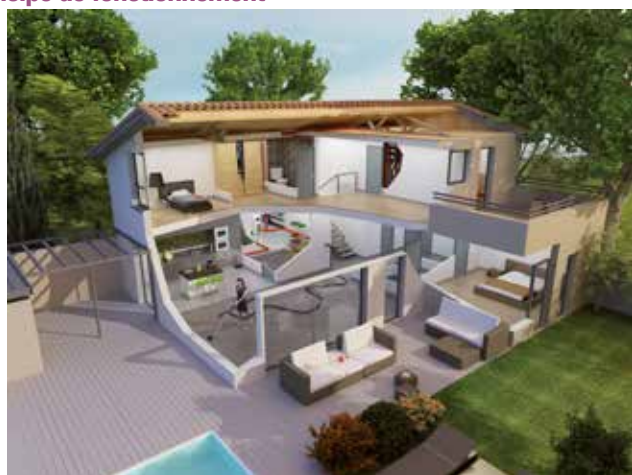
Principe de fonctionnement de l'aspiration centralisée
