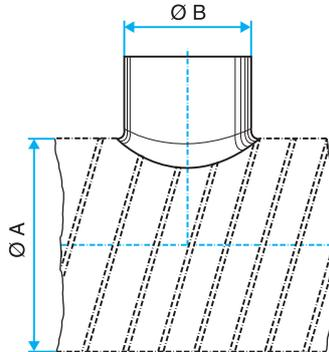
Schéma d'encombrement Piquage Equerre Circulaire en aluminium
